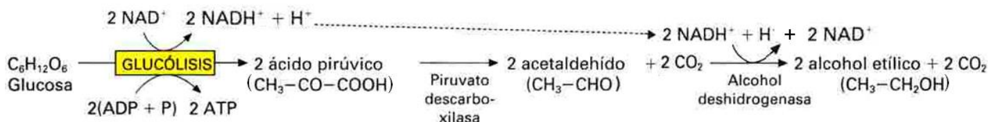
Figura .- Reacciones principales de la fermentación alcohólica.
